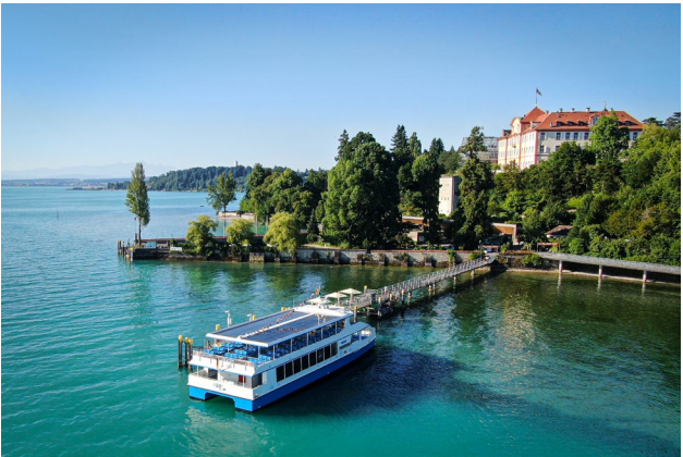
MS „Insel Mainau“ • Baujahr: 2022 300 Passagiere; Antrieb: Batterie ca. 1.000 kWh
